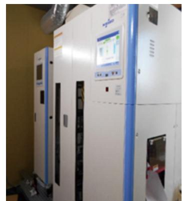
溶解装置と供給装置
